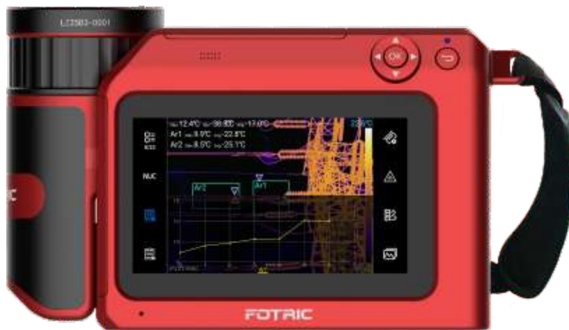
本机现场显示设备历史温升曲线
