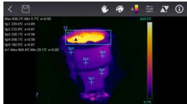
灵活设置各区域不同发射率, 实现不同材质单独准确测量
