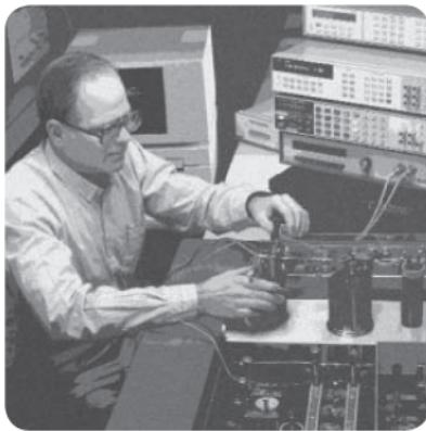
工作于校准实验室的3458A 8.5位数字万用表有卓越的线性度，极低的内部噪声和优异的短期稳定度。3458A 多斜模数转换器的线性度达到当代最高水准。使用阵列 Josephsen 结的本征标准，10V 电压量程的线性度在±0.05 ppm 以内。在1 小时，±0.5°C 条件下，3458A 的10V 电压传递精度达到0.1 ppm。在使用8.5位分辨率时的内部噪声还不到0.01 ppm rms。因此，3458A 是校准用标准数字万用表的正确选择。
