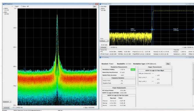
可以方便地进行完善的 WLAN 测量。在下面的 802.11g 信号显示上，三维频谱图显示了初始导频序列，后面是主信号突发。数据包的调制自动检测为 64 QAM，显示为星座图。数据摘要显示 EVM 为 -33.24 db RMS，突发功率测得 10.35 dBm。SignalVu-PC 选项适用于 40 GHz 带宽的 802.11a/b/l/g/p、802.11n 和 802.11ac。
