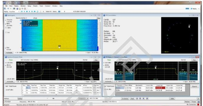
播放记录的信号可以把观看和等待频谱违规的时间从几小时缩短到几分钟, 在桌面复核记录的数据。记录长度只受存储介质容量影响。SignalVu-PC 选项 SV56 播放可以全面分析所有 SignalVu-PC 测量, 包括 DPX 三维频谱图。在播放过程中保持最短信号持续时间指标。可以执行 AM/FM 音频解调。提供可变频宽、解析带宽、分析长度和带宽。可以在记录的信号上执行频率模板测试, 支持频宽最高 40 MHz, 在模板违规时采取不同操作, 包括发出蜂鸣声、停止采集、保存轨迹、保存图片、保存数据。可以选择和循环播放的部分, 重复检查关心的信号。播放可以无限制的, 也可以插入时隙, 缩短复核时间。实时速率播放保证 AM/FM 解调的保真度, 提供 1:1 播放对实际时间。记录的时钟时间在三维频谱图标记中显示, 关联真实世界事件。下图中正在播放 FM 频段, 并使用模板检测频谱违规, 同时在 92.3 MHz 中心频率侦听 FM 信号。
