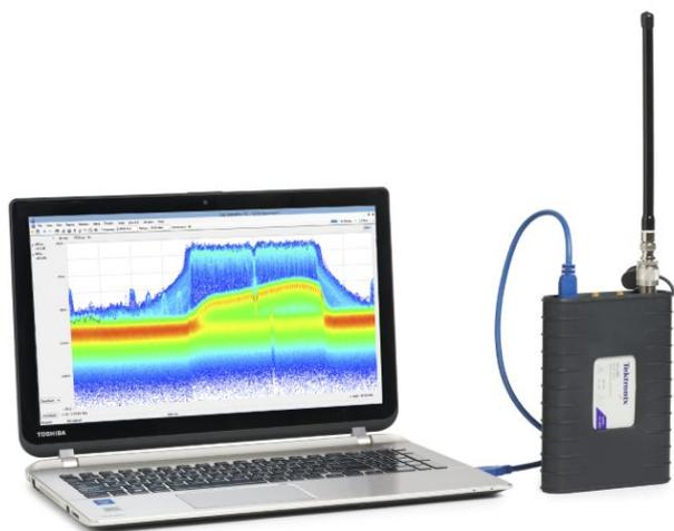
RSA306 使用电脑和泰克 SignalVu®-PC RF 信号分析软件，为 9 kHz ~ 6.2 GHz 的信号提供实时频谱分析、流式捕获和深入信号分析功能，而且价格低、携带方便，特别适合现场、工厂或学术机构使用。
